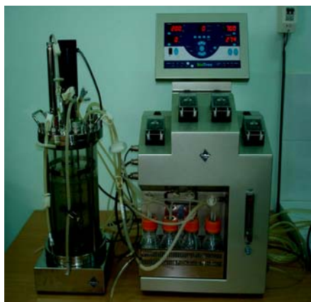
Hình 7.3. Nuôi cấy dịch huyền phù tế bào thực vật trên máy lắc. A: Nuôi trong bình tam giác có lắc để chuẩn bị tế bào. B: Nuôi trong hệ lên men lắc để sản xuất sinh khối.
